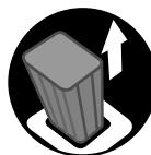
Tirar a bateria do aparelho antes de efectuar qualquer trabalho de reparação e de manutenção. Por isto não há nenhum arranque involuntário do motor.
