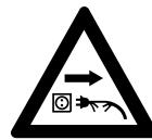
De netkabel van de acculader regelmatig op beschadigingen controleren. Bij beschadiging van de netkabel direct de netsteker uit de contactdoos trekken – **levensgevaar door elektrische schokken!**
