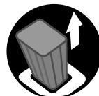
Voor alle reparatie- en onderhoudswerkzaamheden de accu uit het apparaat nemen. Hierdoor wordt het onbedoeld aanlopen van de motor voorkomen.
