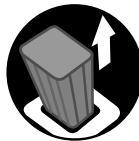
De accu uit het apparaat nemen. Hierdoor wordt het onbedoeld aanlopen van de motor voorkomen.
